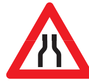
A 43,1: Indsnævret vej. Der kan forventes vognbaneskift eller sammenfletning.
