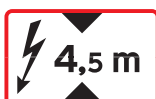
UA 73: Varsling af elektrificeret bane. Jernbaneoverkørsel med 4,5 m fri højde under strømførende køreledning.
