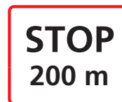
UB 11,1: Forvarsling af den ottekantede færdselstavle Stop B 13 (kan også anvendes ved jernbaneoverkørsel).
