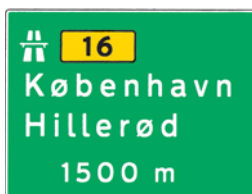
I 18: 1500-m frakørselstavle for forbindelses-anlæg til anden motorvej.
