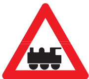
A 72: Jernbaneoverkørsel uden bomme.
