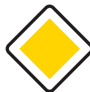
B 16: Hovedvej. Færdslen fra sideveje har ubetinget vigepligt. Parkering på kørebanen er forbudt uden for tættere bebygget område.
